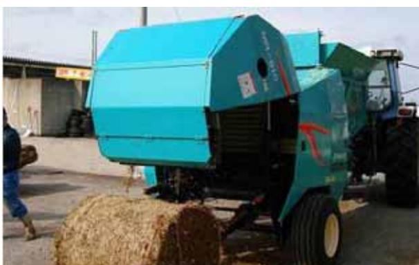
写真: 裁断型ロールベラー原典: 良質飼料の集約的生産 <http://www.nlbc.go.jp/tottori/ex-esa>
