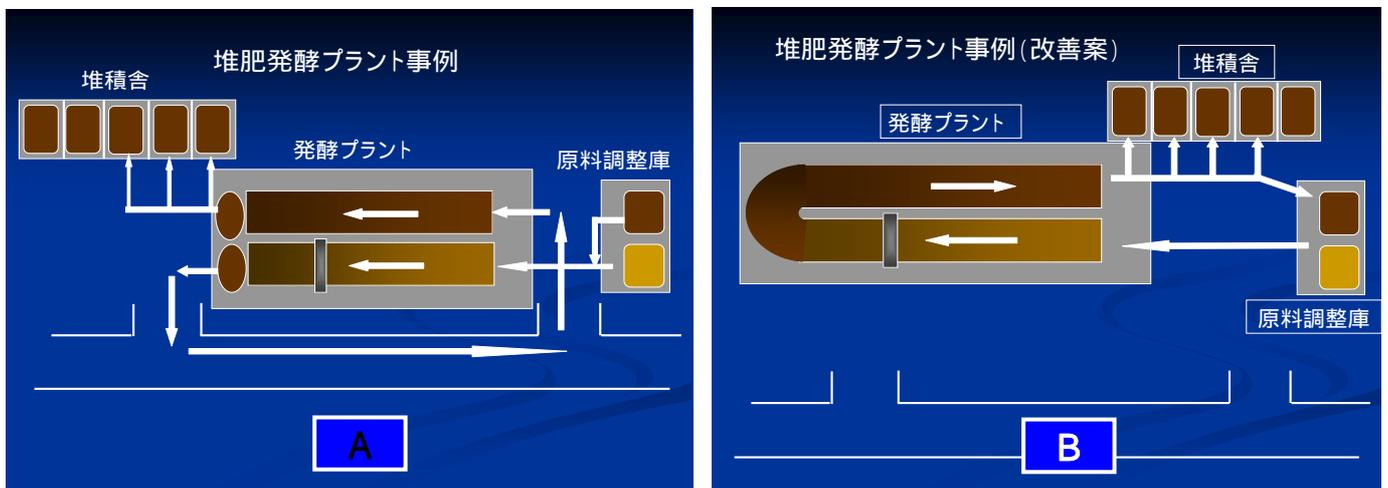
上の図は3戸で共同利用の堆肥発酵プラントを使っている農場での事例です。左のA図が現状で、矢印で示しているのが堆肥製造過程の堆肥の動きです。発酵プラントの中を除いて、他の矢印のところは皆、人の動きが伴っています。見てわかるように矢印がとても複雑で、行ったり来たりしています。人の動き方、つまり作業動線がとても複雑で長く、作業効率が悪くなっていますのが解りますよね。
